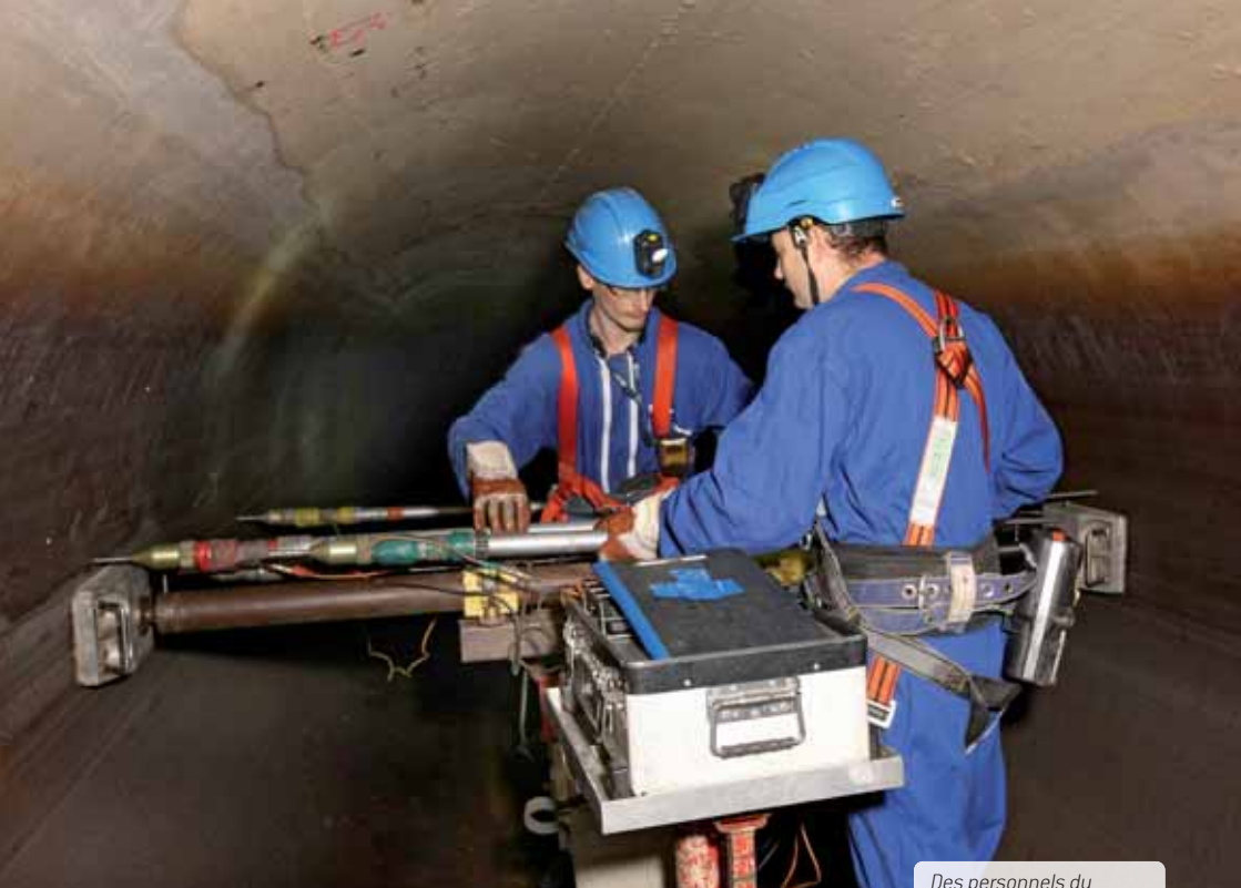
Des personnels du service Mécanique d'auscultation des conduits (MAC) testent la résistance de la conduite tous les cinq mètres environ afin de repérer d'éventuels problèmes et de planifier des travaux.
